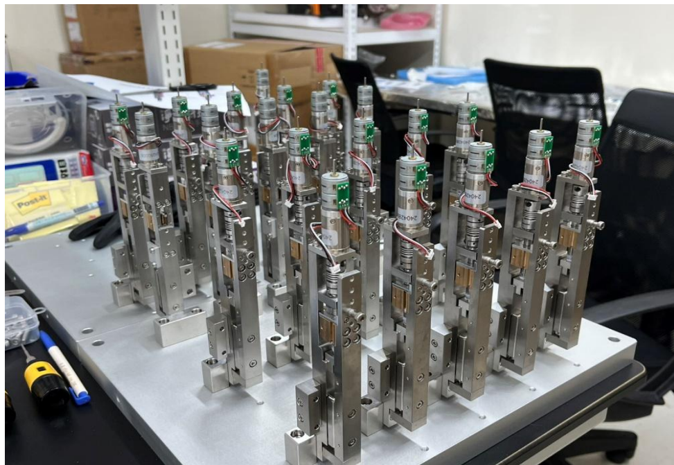
圖二十二、組裝完工的致動器
