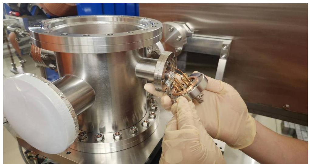
圖十三、XBPM 安裝到真空設備內並進行接點測試
