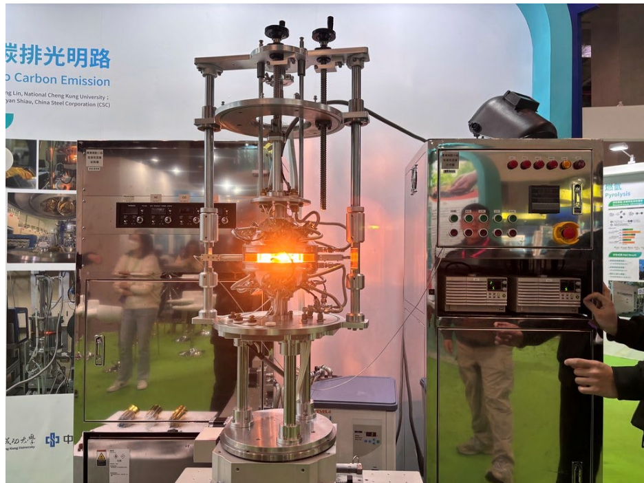
圖二、本中心採用獨家技術打造的臨場氫氣高溫爐
