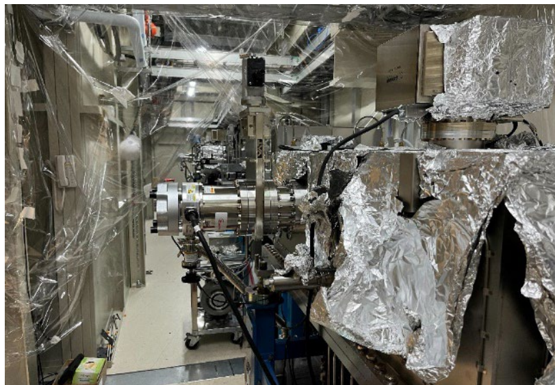
圖三、完成鏡面安裝的鏡箱，進行真空烘烤中
