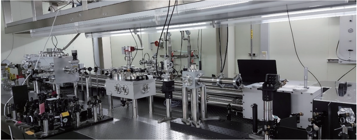
圖二 TPS 30A 潔淨室中 80 W Yb-KGW 高功率雷射光源系統照。
